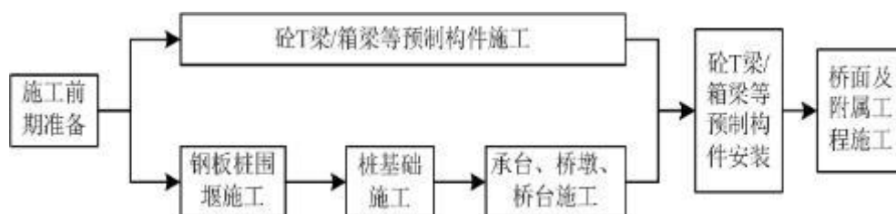
图 2.11 桥梁总体施工工序
